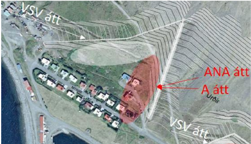
Mynd 10.9 Yfirlitsmynd af líklegum skaflamyndarsvæðum við Urðargarð (Verkís, 2016b). Rauðlituð svæði sýnir líklega skaflamyndun í ANA og A átt en hvítlituð svæði sýnir líklega skaflamyndun í VSV átt.
