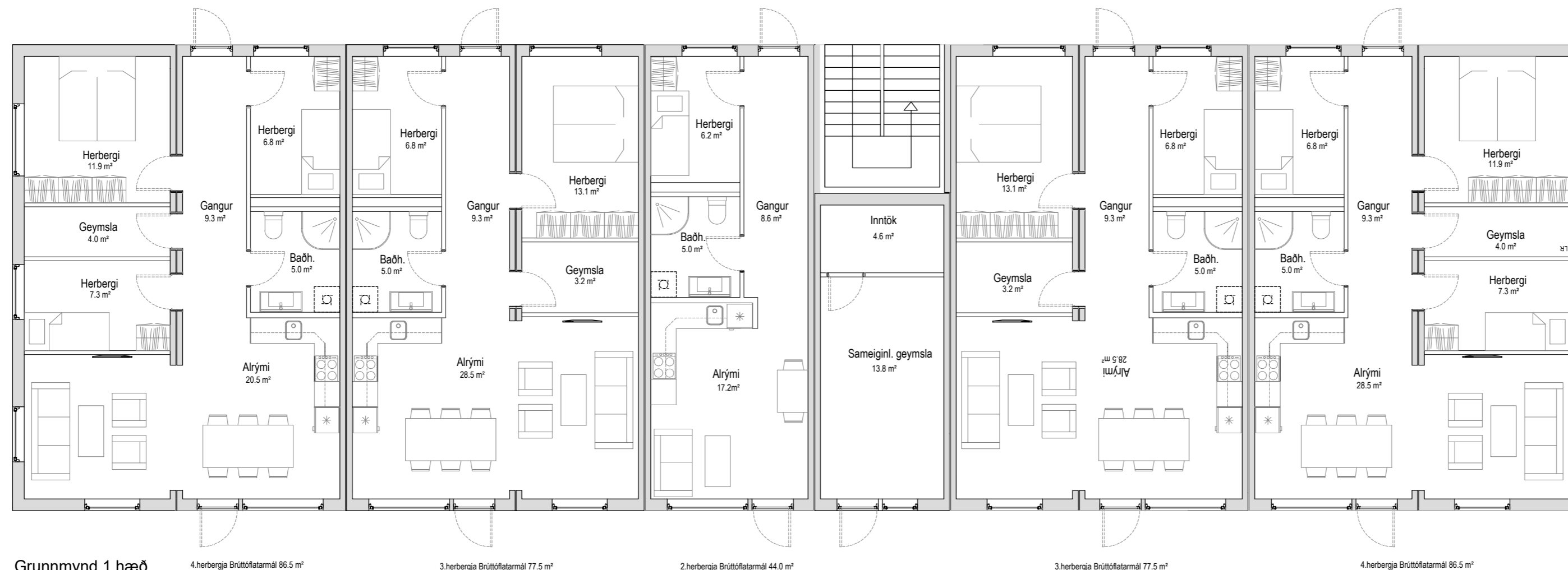
Grunnmynd 1. hæð Mkv 1:100
